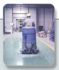
全新吸水刮刀組防撞設計 ~ 當碰到障礙物能順勢安全滑開, 保證所有污水能完全吸收。
