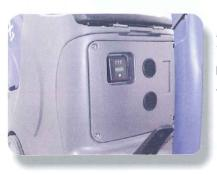
原廠內置式微電腦充電器可顯示充電電流、電壓、時間,節省了儲存空間,使充電更靈活方便。 Equipped with a car charger, saving store space, more flexible and convenient to use.
